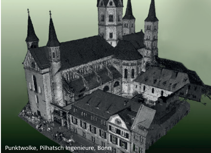
Punktwolke, Pilhatsch Ingenieure, Bonn
